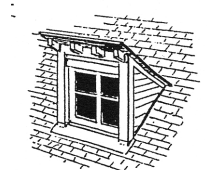
lucarne retroussée, ou demoiselle ; c'est aussi le vrai "chien assis"
