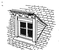
lucarne retroussée, ou demoiselle ; c'est aussi le vrai "chien assis"
